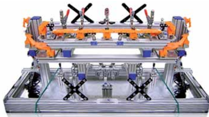
Modifiering av fixtur för främre kofångare till Volvo.
