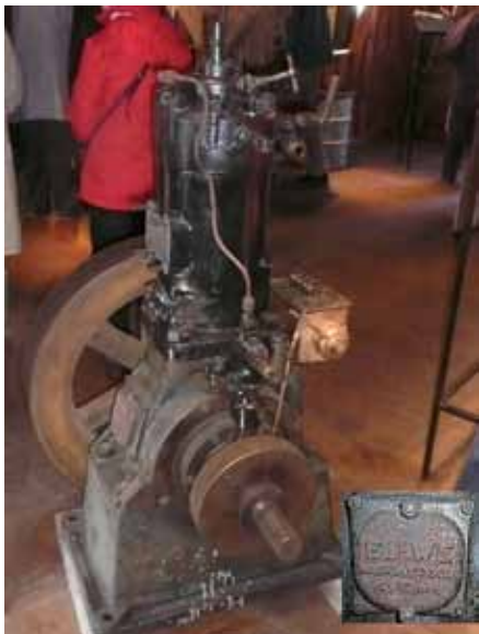
En encylindrig råoljemotor från Ellve Maskinverken i Sverige. Dessa motorer utvecklades vid sekelskiftet av Harry Leisner och tillverkningen startade i Svenska Maskinverken i Södertälje.
