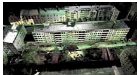
Punktmoln med färginformation från 3D-laserscanning innan påbyggnad av Brf Statären i Sundbyberg.
