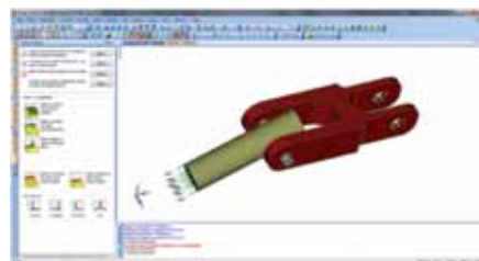
Figur 3. SolidEdge CAD modell med kolvlast och lösningar i hålen.
