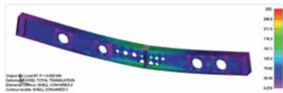
Spänningar i en balk med många håltagningar.
